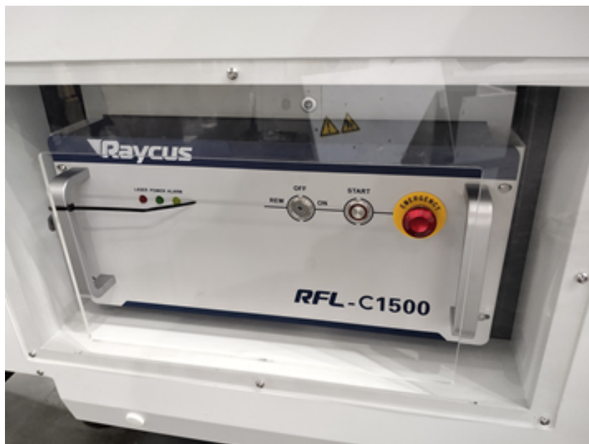
A vész leállító gomb a lézer berendezésen
