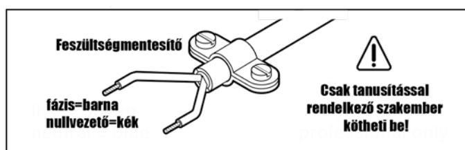
Ne csatlakoztassa a kék vagy barna vezetéket a földcsatlakozóhoz. Ha valamilyen okból kifolyólag eltávolítja a dugót a kábelről, biztonságosan áramtalanítsa.
